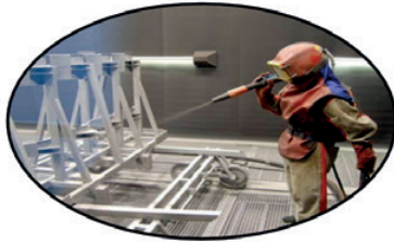
JATO DE GRANALHA
